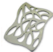
Schmuckindustrie Gold LASER Nd: YAG Materialdicke: 0,3 mm Schnittgeschwindigkeit: 600 mm/min Schnittbreite: 40 µm
