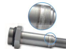
Industrieanwendung LASER Nd: YAG gepulst Stahl Eindringen: 1,5 mm Schweißzeit: 4 Sekunden
