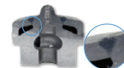
Schiffsbauindustrie: LASER CO 2 Stahl Eindringtiefe: 2 mm Schweißdauer: 3,5 Sekunden
