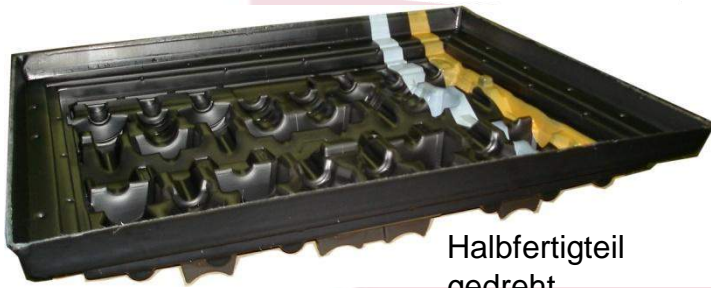
Halbfertigteil direkt aus dem Inliner
