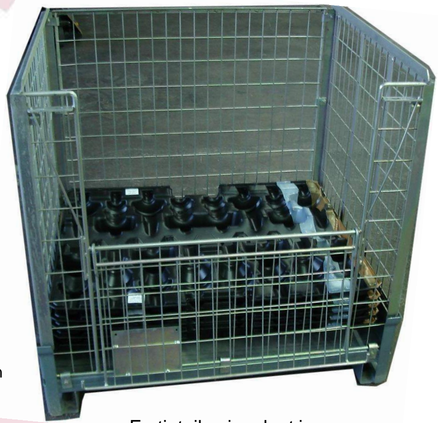
Fertigteile eingelegt im Umbehälter
