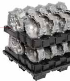
Verpackung Getriebegehäuse: selbsttragende Verpackung, Material: HD-PE, Materialstärke: 8-10 mm
