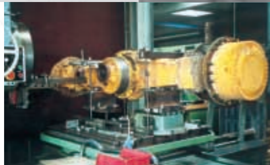
Instandsetzung einer Radladerachse
