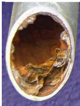
Abb.2: stark korrodiertes Rohr im Querschnitt.
