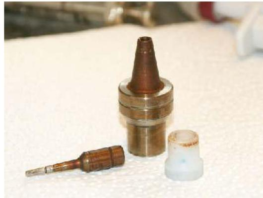
Abb.1: Ventil aus einer Hochdruckpumpe.
